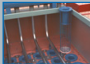
Einbausituation der Stützkörbe mit Venturi, Filterschläuche und Luftstrahlrohre
